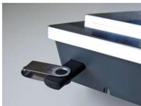
Der USB- Stick wird automatisch erkannt. Hierzu muss die Hauptkommunikation auf USB-Host stehen. Sie sehen die direkt im Display an diesem Symbol (Icon)
