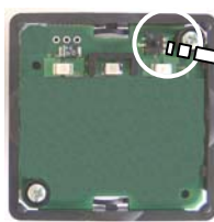
Frontmodul mit integrierter Leserelektronik
