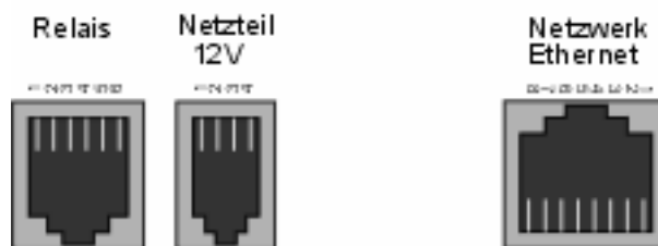
Rückansicht CPT-90 X(4) mit Ethernet Schnittstelle
