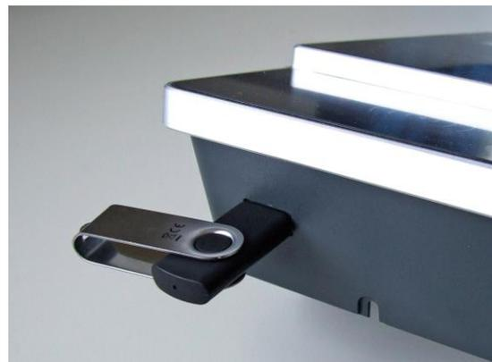
Der USB- Stick wird automatisch erkannt. Hierzu muss die Hauptkommunikation auf USB-Host stehen. Sie sehen die direkt im Display an diesem Symbol (Icon)
