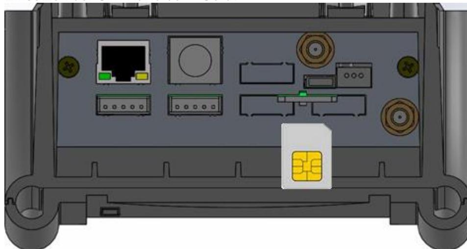
Die SIM-Karte muss in dieser Lage in das Gerät eingesteckt werden.
