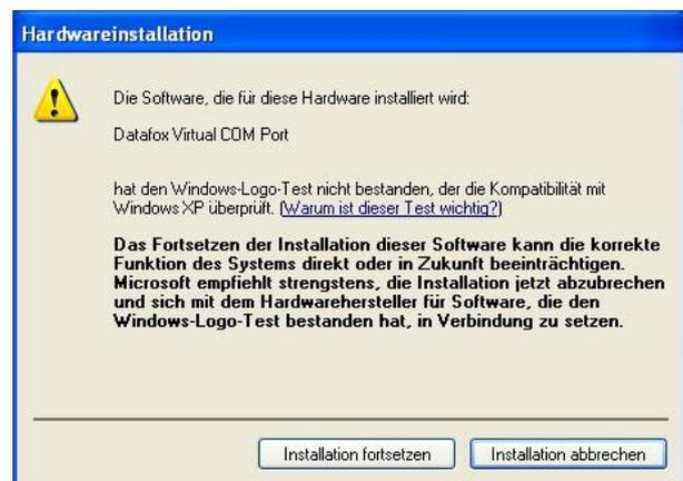
Im Geräte-Manager ist nun ein zusätzlicher COM Port vorhanden „Datafox Virtual COM Port“. Über diesen COM Port können Sie mit dem DatafoxStudioIV oder Ihrer eigenen Anwendung über die DFCOMDLL.dll eine Verbindung zum MasterIV Gerät aufbauen.
